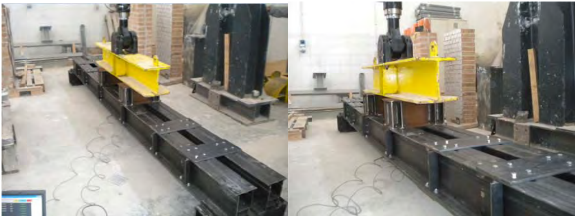
Figura 110 - Deformate delle travi ORP200 in corrispondenza del carico di plasticizzazione
