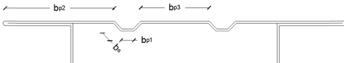
Figura 17 - Soluzione di irrigidimento della flangia con 2 bugne
